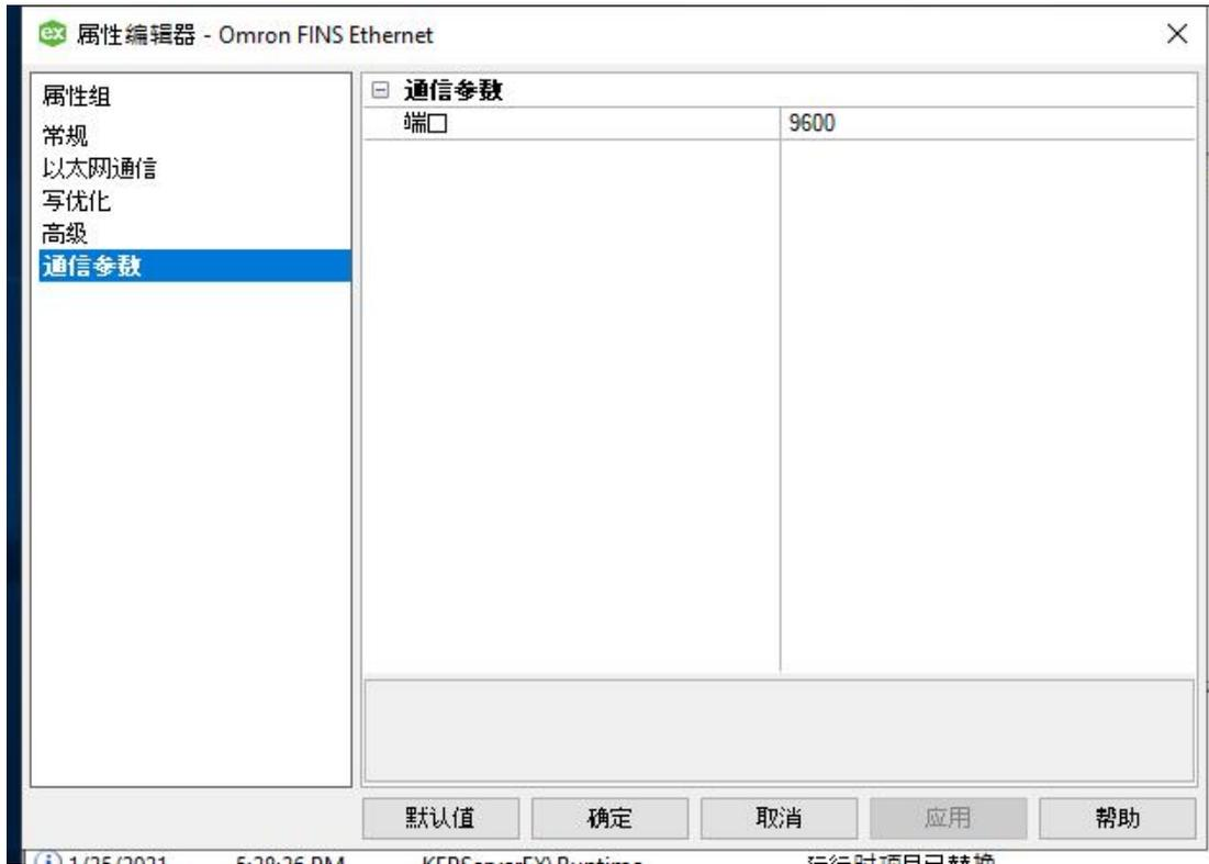
**端口:** 指定本地以太网上的设备要使用的端口号。FINS 要求源和目标端口号相同。有效范围为 1 到 65535。默认设置为 9600。
