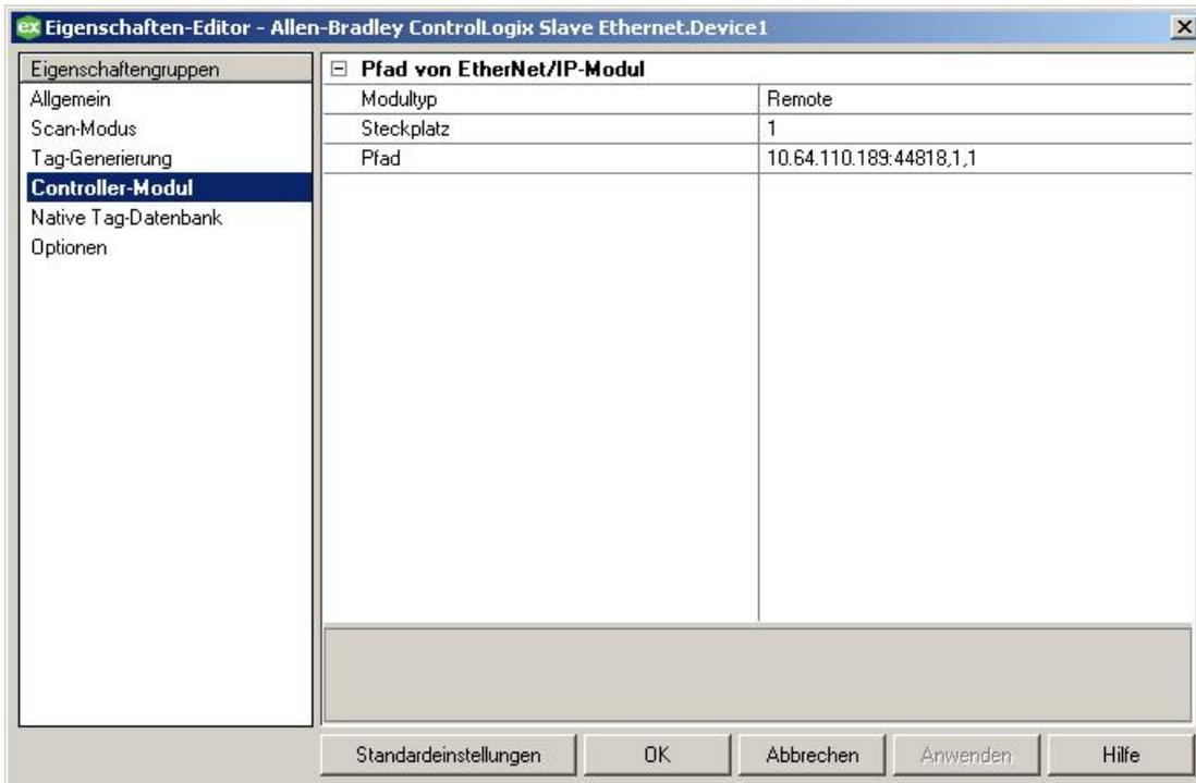
**Modultyp:** Mit dieser Option wird überprüft, ob das Gerät "Lokal" (Teil des simulierten EtherNet/IP-Moduls) oder "Remote" (erfordert Steckplatznummer für EtherNet/IP-Routing) ist. Eine lokale CPU und bis zu 15 Remote-CPU's sind möglich.
