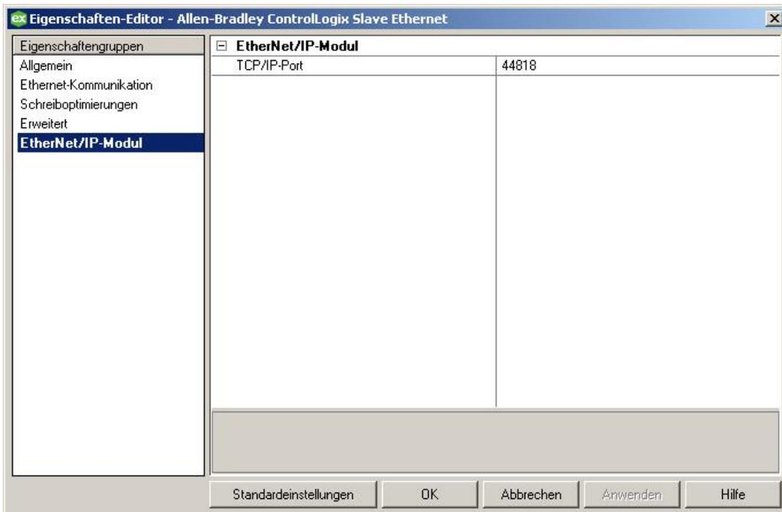
**TCP/IP-Port:** Gibt den TCP/IP- und UDP-Port an, der einen eindeutigen Kommunikationskanal für das EtherNet/IP-Modul bereitstellt. Der gültige Bereich liegt zwischen 1 und 65535. Die Standardeinstellung ist 44818.
