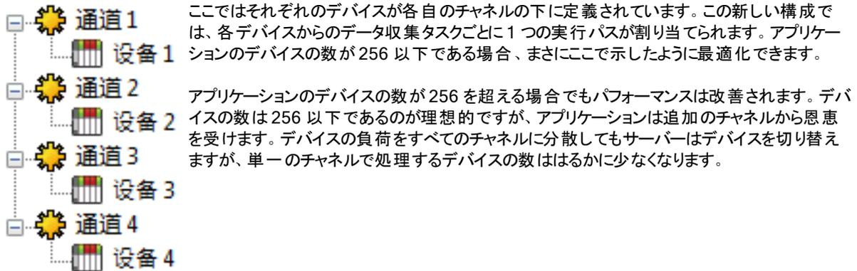
ここではそれぞれのデバイスが各自のチャンネルの下に定義されています。この新しい構成では、各デバイスからのデータ収集タスクごとに 1 つの実行パスが割り当てられます。アプリケーションのデバイスの数が 256 以下である場合、まさにここで示したように最適化できます。
